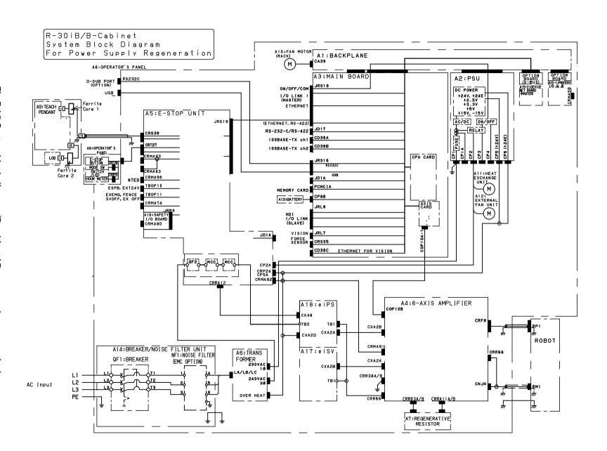
Fig.B (d) System block diagram (B-cabinet / Power supply regeneration)
