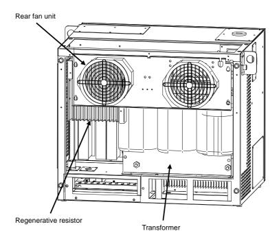
Fig.2.1 (d) R-30iB A-cabinet interior (Rear)
