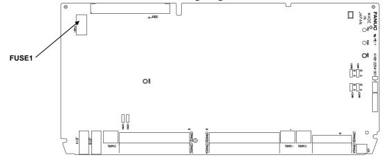
Fig.3.6 (d) Fuse on the Process I/O board JA,JB
