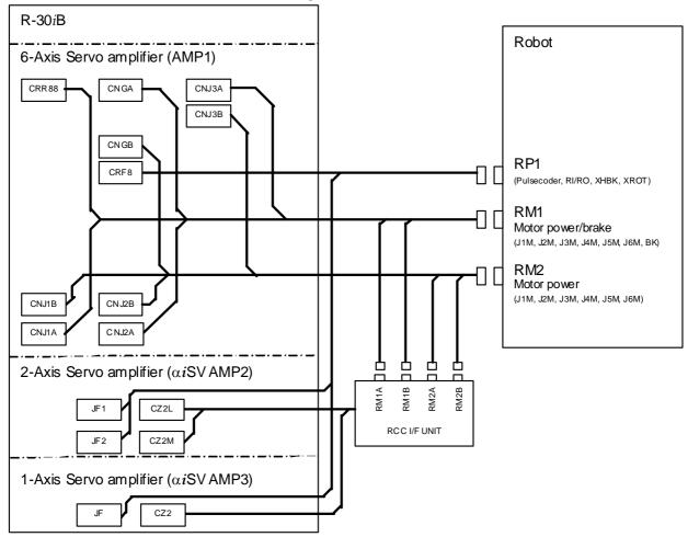
Fig.3.3.1 (d) Robot connection cable (Group5)
