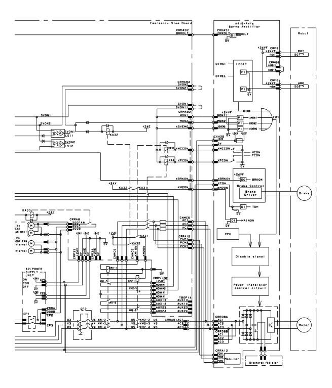
E-STOP CIRCUIT FOR A-CABINET POWER SUPPLY REGENERATION
